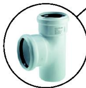
Рис. 3: Сборно-соединительный и вертикальный трубопровод Wavin AS размер DN 90. Ответвление под углом 87° со скругленным стыком имеет гидравлически оптимизированную конструкцию. При конструировании ответвлений со скругленным стыком как при малом продолжительном стоке, так и при кратковременных высоких нагрузках промывка уборной должна обеспечивать вентиляцию и аэрацию в нисходящем трубопроводе и в соединительном трубопроводе.
