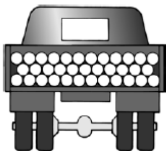
Рис. 34: Транспортировка распакованных труб Wavin AS
