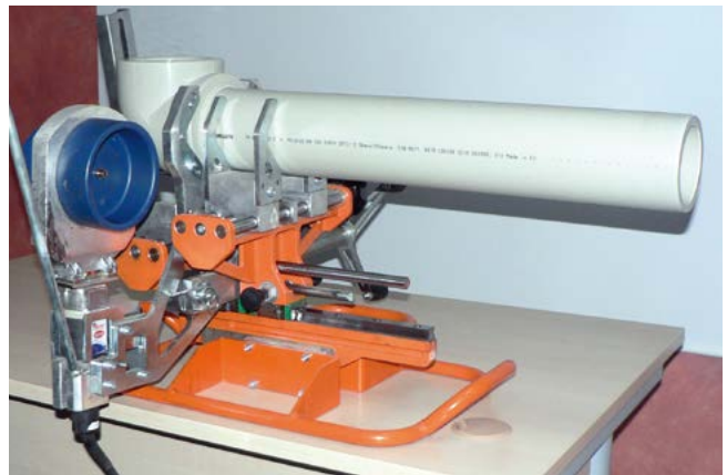
готовое сварное соединение после охлаждения
