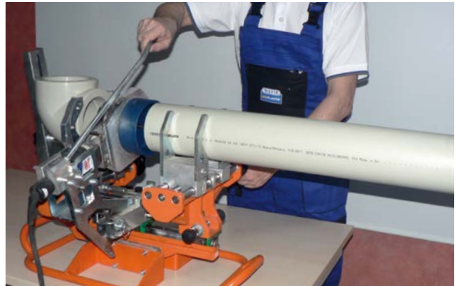
закрепление в аппарате и центровка, потом нагрев
