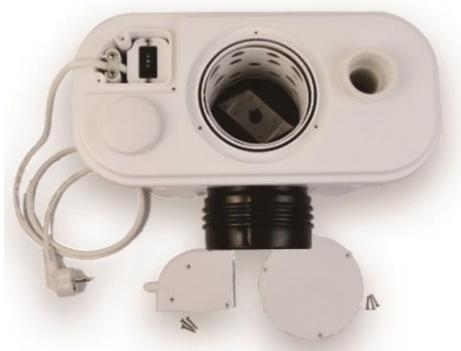
При остановке устройства по данной причине снимается отдельная малая крышка расположенная на основной крышке над кабельным вводом и переключателем осуществляется реверс мотора.
