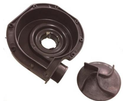
Измельчитель выполнен в виде неподвижной турбины из ножевых пластин, смонтированных на всасывающем отверстии корпуса гидравлической части насоса (улитки) с внутренним спиралевидным каналом.
