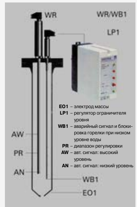
Объемный электрод с ограничителем уровня воды
