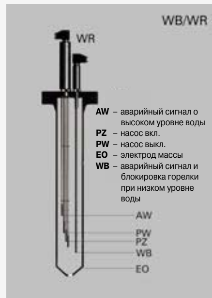
Универсальный полиэлектрод для двухпозиционного регулирования уровня воды
