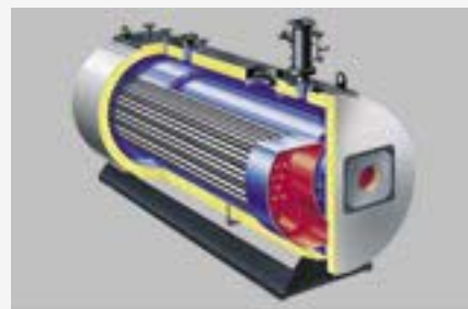
Vitomax 200 HW 375-2090 кВт Трехходовая конструкция котла с возможностью установки консоли для монтажа горелки
