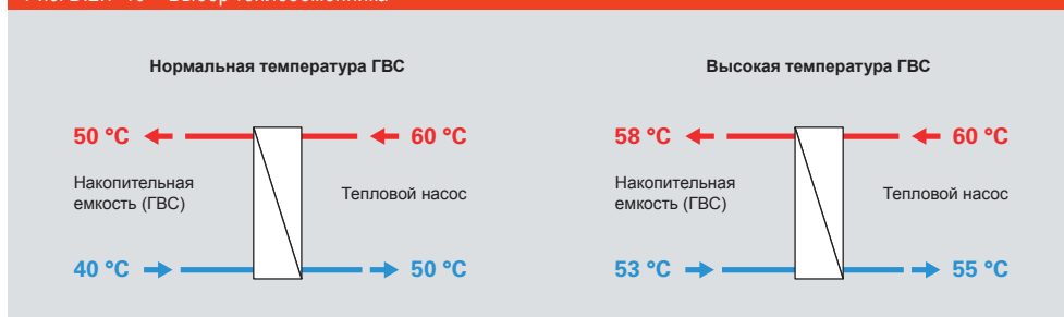
Рис. D.2.1-16 Выбор теплообменника
