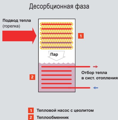
Рис. А.5.3–1 Принципиальная схема адсорбционного теплового насоса
