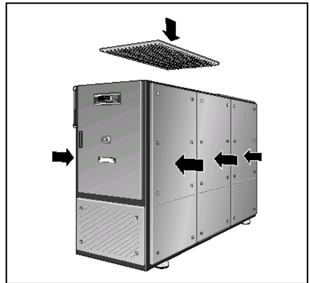
Рис. 13 Монтаж элементов шумопоглощающего кожуха
