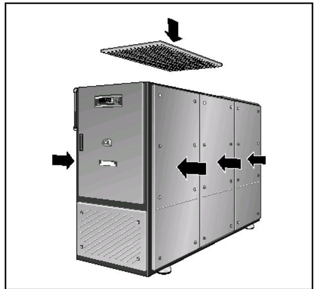
Рис. 13 Монтаж элементов шумопоглощающего кожуха
