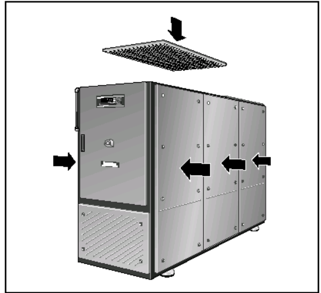
Рис. 13 Монтаж элементов шумопоглощающего кожуха
