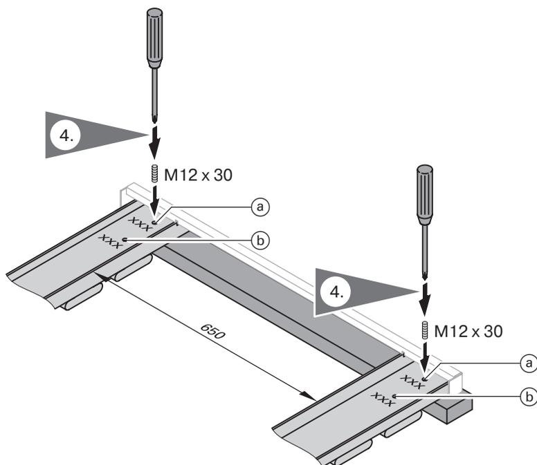
Ⓐ или Ⓑ: положение определить по маркировке размеров котлового блока (xxx)
