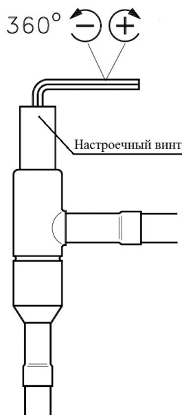
Рис. 3.4 Настройка регулятора давления конденсации
