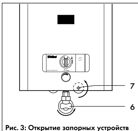
Рис. 3: Открытие запорных устройств
