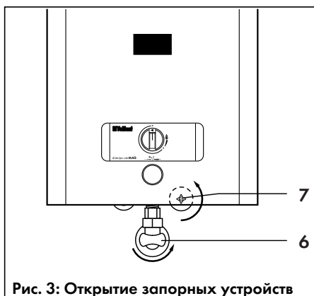
Рис. 3: Открытие запорных устройств
