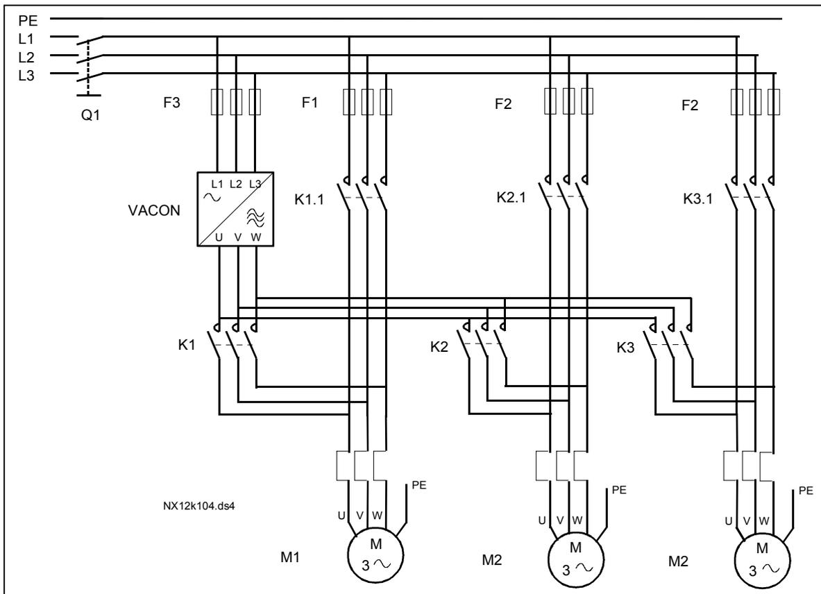
Рис. 1-31. Пример автозамены среди 3 насосов, силовая схема
