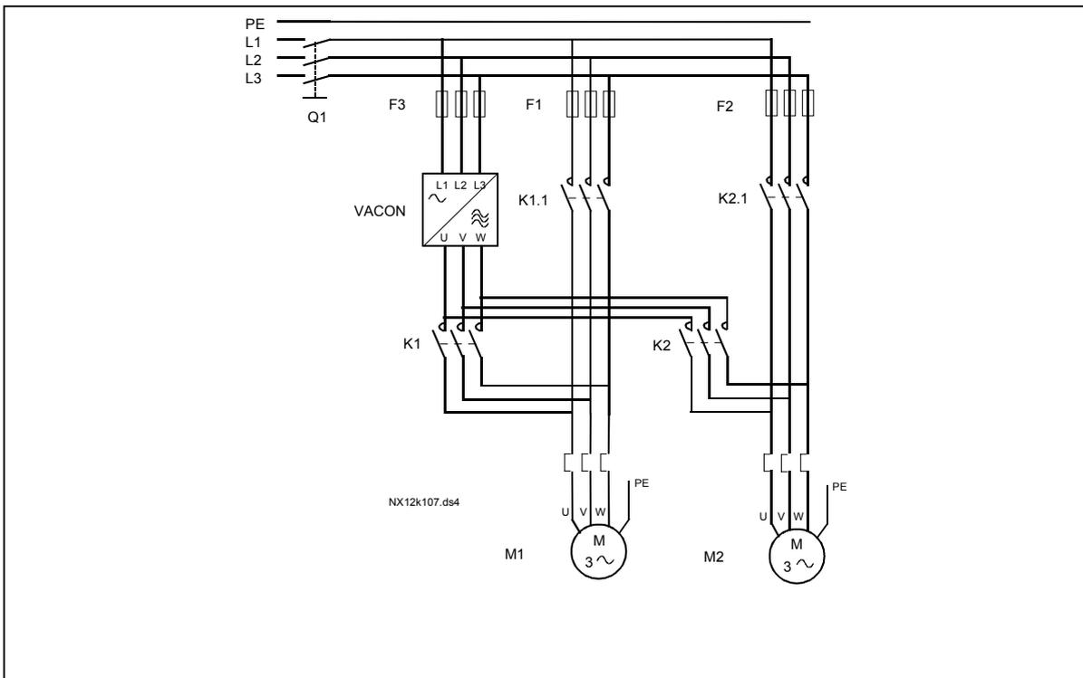
Рис. 1-33. Пример автозамены среди 2 насосов, силовая схема
