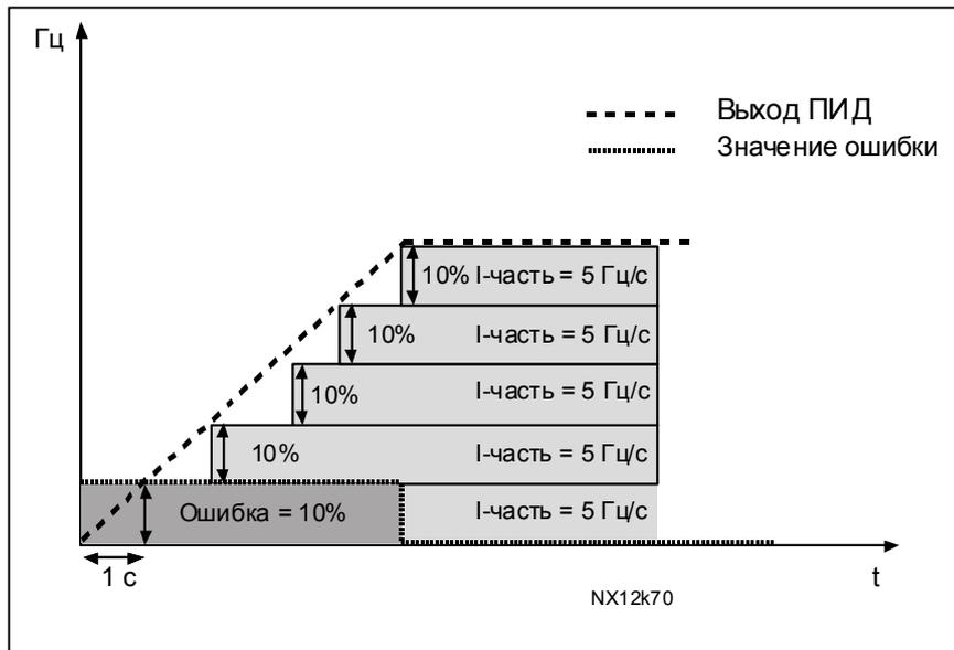
Рис. 1-25. ПИД-регулятор работает как И-контроллер
