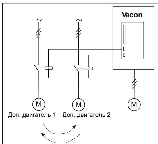
Рис. 1-34. Автозамена относится только к дополнительным приводам.
