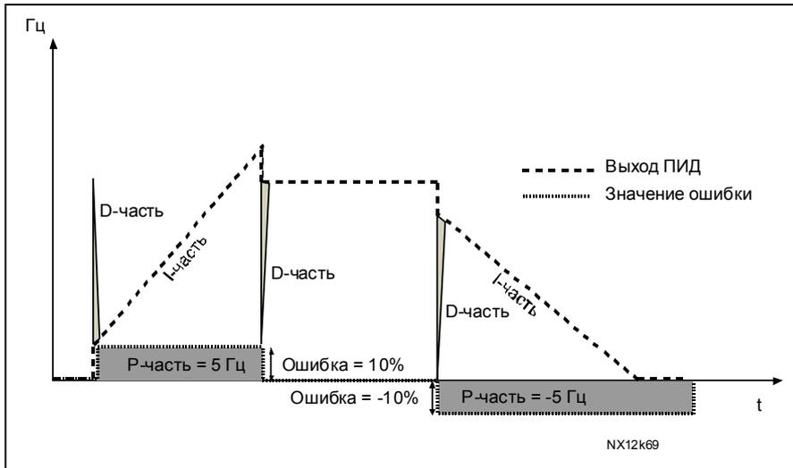
Рис. 1-26. Кривая на выходе ПИД-регулятора в примере 2
