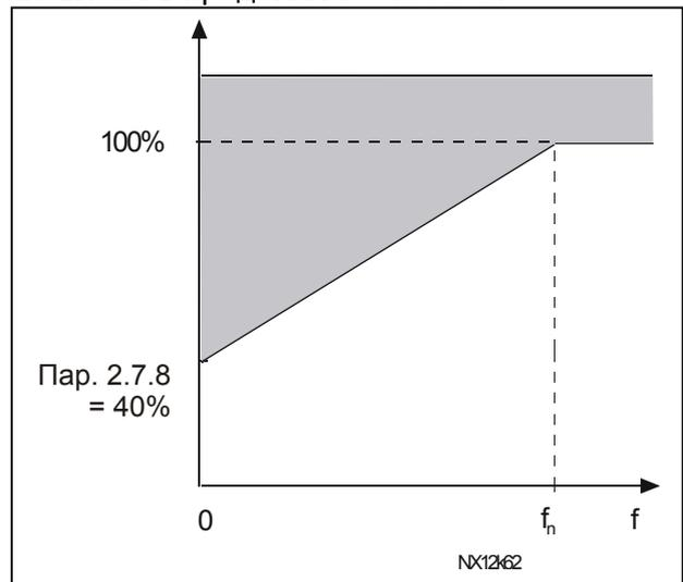
Рис. 1-18. Мощность охлаждения двигателя
