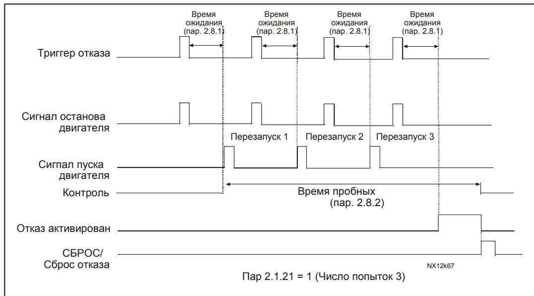
Рис. 1-24. Автоматический перезапуск
