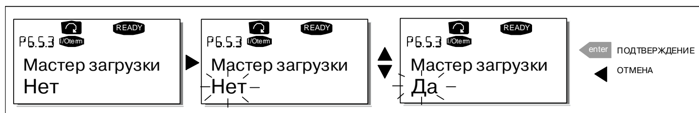
Рисунок 7-16. Активирование функции Мастер загрузки
