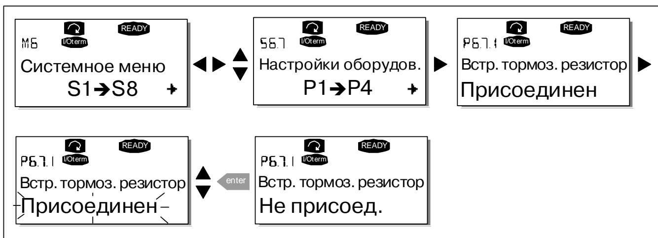
Рисунок 7-21. Подключение встроенного тормозного резистора
