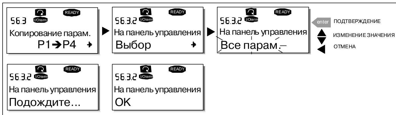
Рисунок 7-12. Копирование параметров в панель управления
