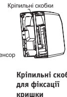
Мал. 4 Кріпильні скобки для фіксації кришки
