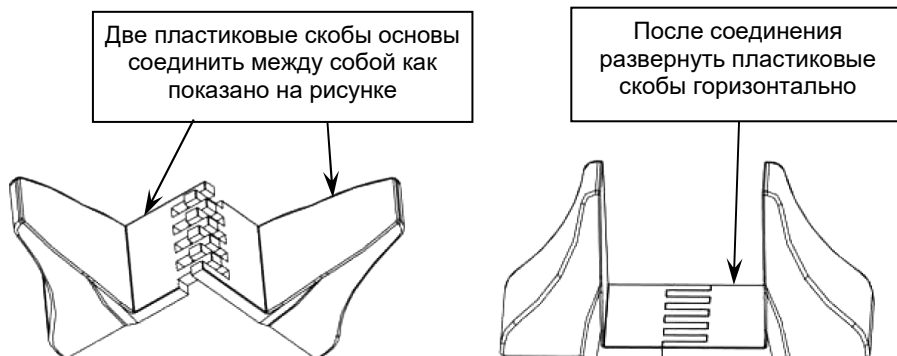
Рисунок 3 - Сборка пластиковых основ для вертикальной установки изделия.
