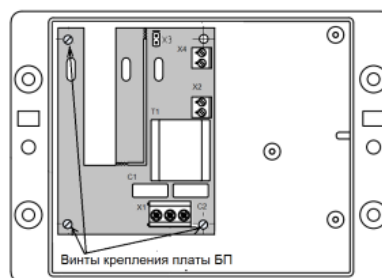
Рис.2 – Схема монтажа БП/ВКТ-7 в корпусе вычислителя
