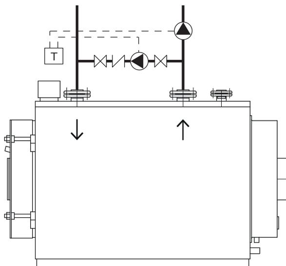
Рекомендуется, чтобы температура воды в контуре котла была независимой от требуемой температуры воды в системах потребления тепла и не ниже 65°С. Это обеспечивает более длительный срок службы котла.
