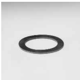
Katalog-Nr. und -bezeichnung DCU – Dichtung aus AFM 34, für Verschraubung aus Kupfer/Rotguss und Edelstahl, geprüft nach DIN 3535 Teil 6 – hergestellt ohne Asbest – temperaturbeständig bis 200 °C maximal – Einsatzbereich: Wasser, Dampf, Alkohole, Glykole, Öle auf Kohlenwasserstoffbasis, brennbare Gase
