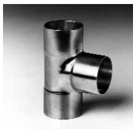
Katalog-Nr. und -bezeichnung 5130 – T-Stück, allseitig mit Innenlötende
