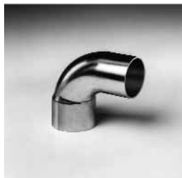
Katalog-Nr. und -bezeichnung 5092 – Winkel 90°, mit Innen- und Außenlötende
