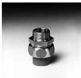
Katalog-Nr. und -bezeichnung 5343g – Verschraubung, konisch dichtend, Lötuffe aus Kupfer, mit Innenlötende, Einschraubteil Außengewinde
