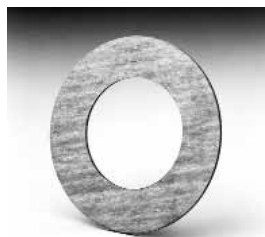
Katalog-Nr. und -bezeichnung FL-D – Hochdruck-Flanschdichtung asbestfrei für Vor-schweiß-, Gewinde-, Press- und lose Flanschen geeignet bis maximal 400°C, beständig gegen Wasser, Dampf, Treibstoffe, verdünnte Laugen, Öle, Gase (DVGW-geprüft nach DIN 3535 Teil 6). Abmessungen nach DIN EN 1514-1, 2 mm dick für Flanschen. PN 10/16 = DIN EN 1092-1 und DIN EN 1092-2
