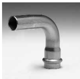
Katalog-Nr. und -bezeichnung 9001A – Bogen 90°, mit Innen- und Außenpressende
