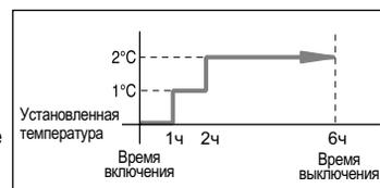
**Обогрев** Установленная температура понижается на 1°C в час. Когда она понизилась на 2°C (через два часа), температура поддерживается на этом уровне в течение четырех часов.
