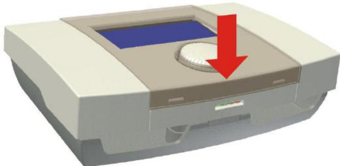
Рис. 19.2 Закрытие корпуса шаг второй
