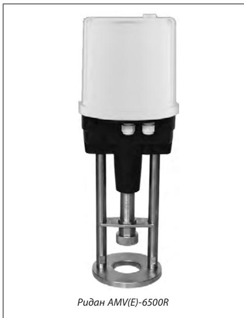
Электропривод предназначен для управления регулирующими клапанами VFM-2R DN 250 и VF-3R DN 100–250. Управление приводом Ридан AMV-6500R осуществляется по импульсному сигналу от трехпозиционных электронных регуляторов Ридан ECL-3R/4R или подобных. Привод Ридан AME-6500R управляется аналоговым сигналом.
