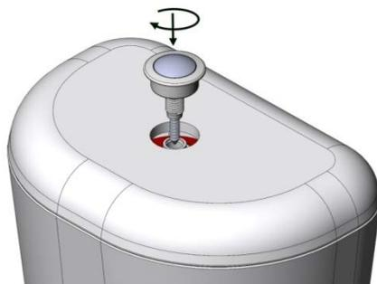
Проверьте, чтобы между крышкой бачка и кнопочным узлом, вставленным в резьбу клапана (не ввинчивая) был зазор 3...19 мм
