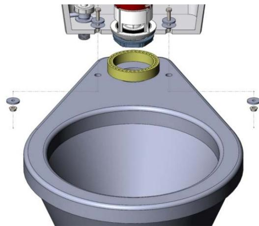
После установки арматуры не допускается касание подвижных частей клапанов друг друга и стенок бачка. Установите прокладку 25 между унитазом и бачком.
