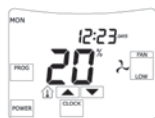
Рис. 6. Меню установки CO2 или постоянного давления Fig. 6. CO2 or constant pressure setting menu Abb. 6 Einstellungsmenü vom CO2 oder vom permanenten Druck
