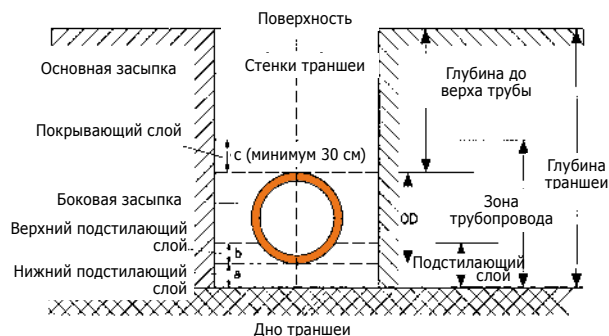
Рис. 3 Устройство траншеи
