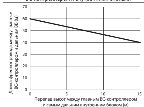
Рис. 1. Перепад высот и длина фреонпровода между ВС-контроллером и внутренними блоками
