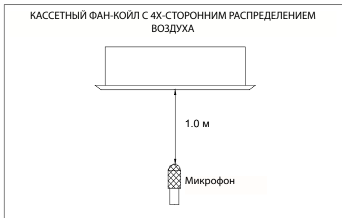
Рисунок №6 Схема испытаний шумовых характеристик агрегатов
