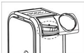
4. Поверните гибкий воздуховод для отработавшего воздуха в направлении изображенной на рисунке стрелки 1 и отделите его от блока кондиционера.
