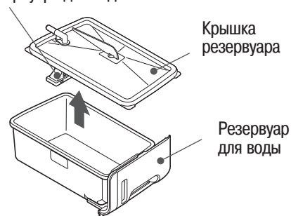
Фильтр резервуара для воды
