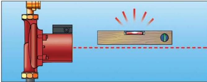
Насос должен быть установлен таким образом, чтобы вал электродвигателя находился в горизонтальном положении.
