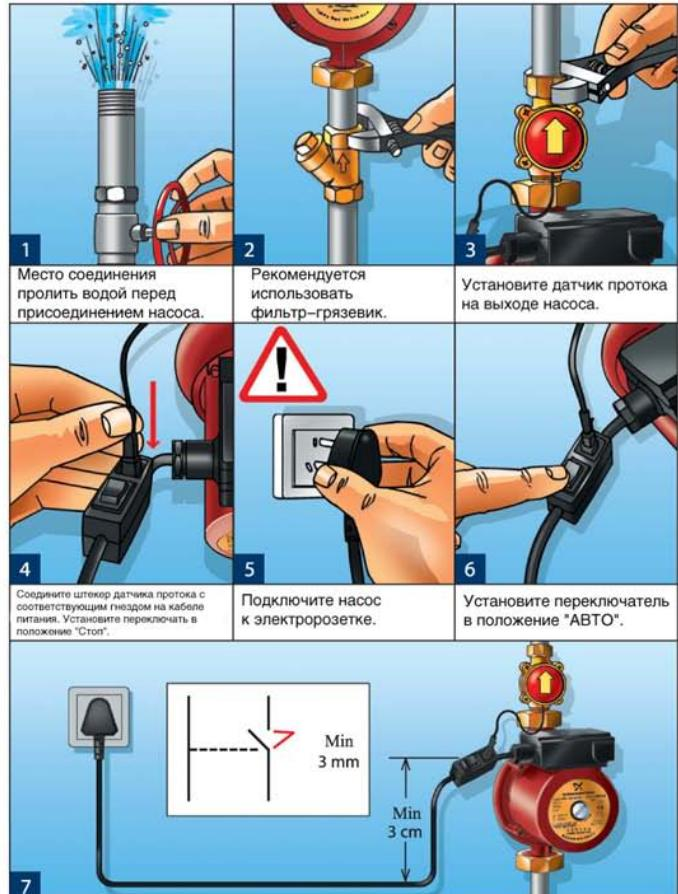
Разъем должен быть заземлен. Все электрические подсоединения должны производиться в соответствии с действующими нормами.
