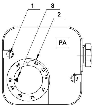
**Fig. 13** 1-Винт заглушка 2-Регулировочная гайка
