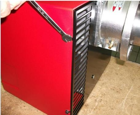
1) Снять кожух, ослабив 4 винта;
