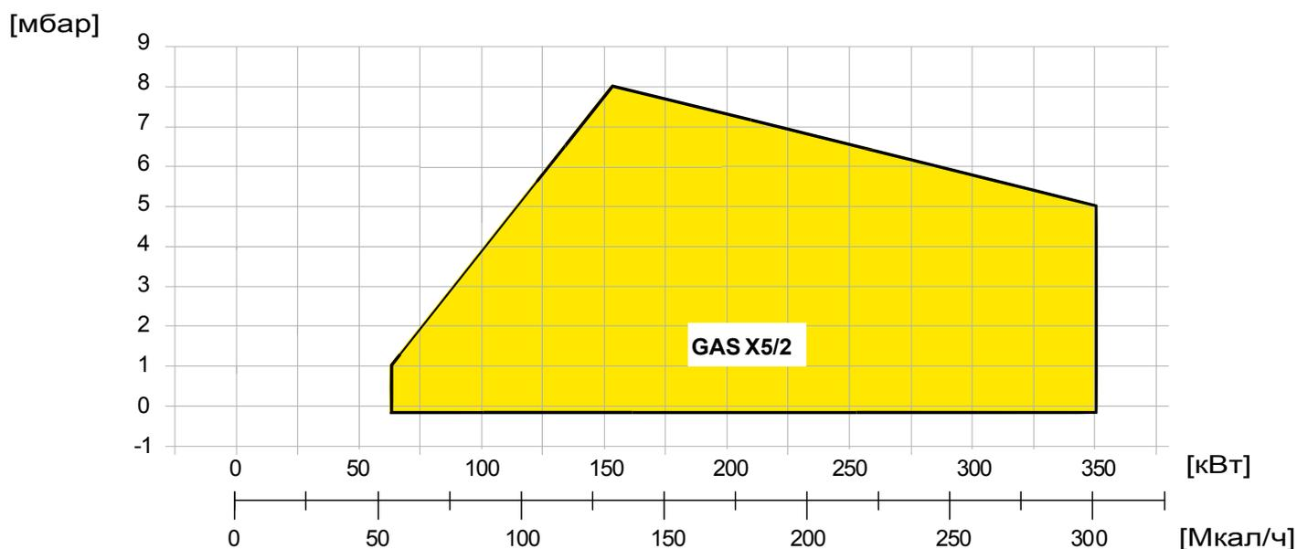
Fig. 3 X = Мощность Y = Сопротивление камеры сгорания
