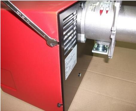
1) Снять кожух, ослабив 4 винта;
