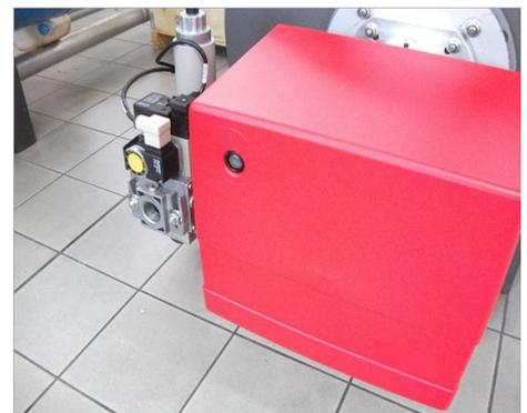
12) Снять заглушку из электроклапан, Подключить газовую арматуру к газопроводу и Переустановите кожух.
