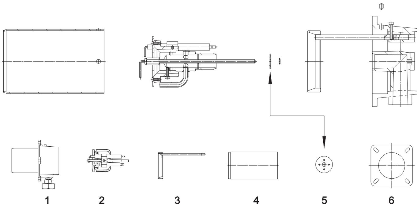
**Fig. 11** 1) СМЕСИТЕЛЬНАЯ ГРУППА 2) СМЕСИТЕЛЬНЫЙ КОМПЛЕКТ 3) РЕГУЛИРОВКА СМЕСИТЕЛЯ 4) СОПЛО
