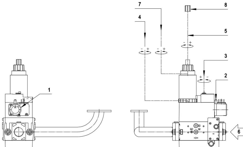
Fig. 19 РЕГУЛИРОВКА ГАЗОВОЙ АРМАТУРЫ МОД.: DUNGS
