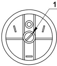
Fig. 14 MOD.SIT: 1- Регулировочный винт
