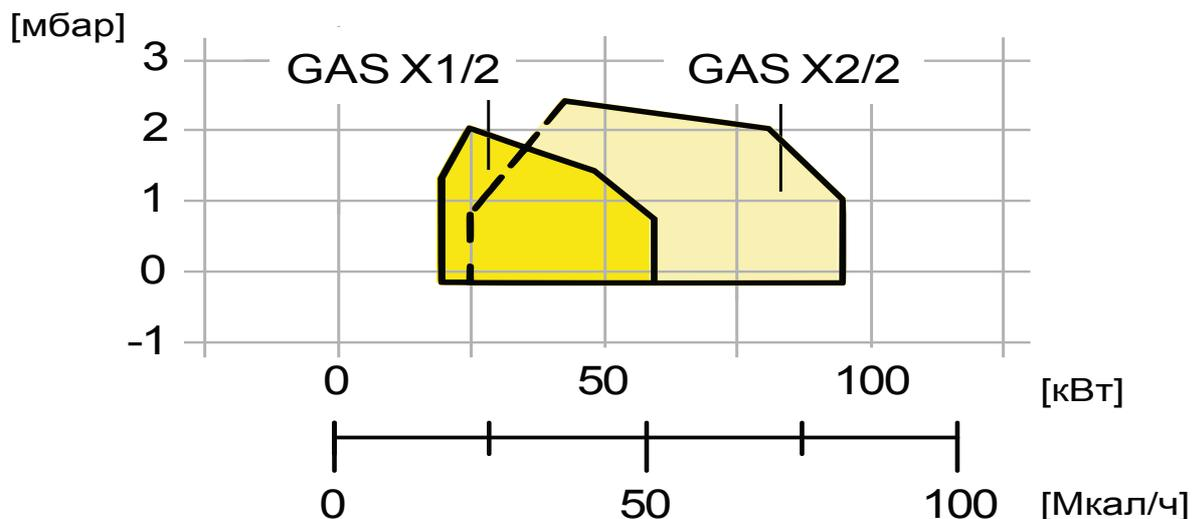
Fig. 1 X = Мощность Y = Сопротивление камеры сгорания
