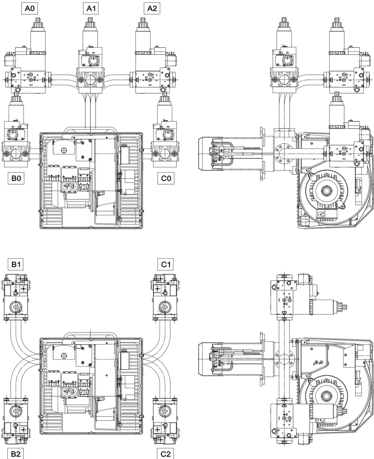
Fig. 10 МОНТАЖНЫЕ ПОЛОЖЕНИЯ ГАЗОВОЙ АРМАТУРЫ GAS X5/2CE
