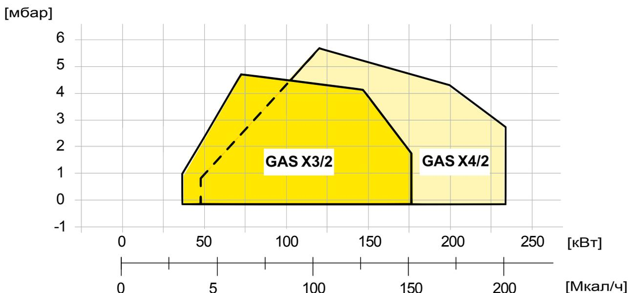
Fig. 2 X = Мощность Y = Сопротивление камеры сгорания
