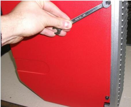
1) Снять кожух, ослабив 4 винта;
