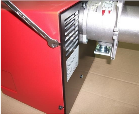
1) Снять кожух, ослабив 4 винта;
