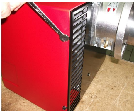
1) Снять кожух, ослабив 4 винта;
