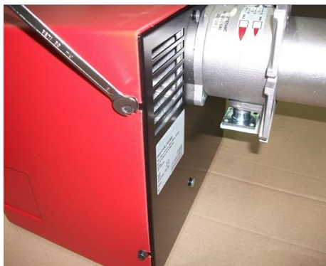
1) Снять кожух, ослабив 4 винта;
