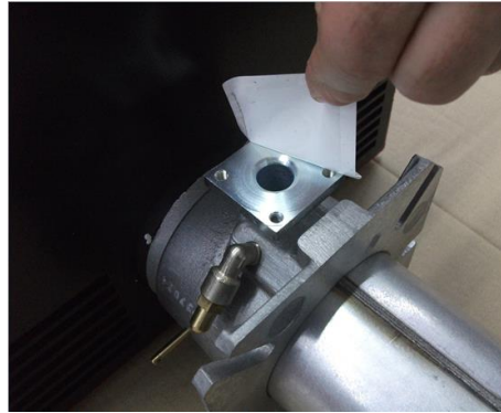
2) повернуть Горелка и Снять заглушку;
