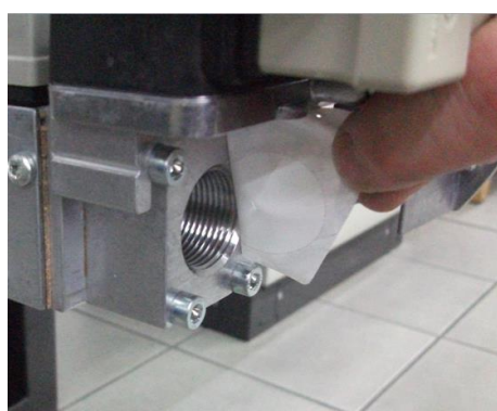
8) Снять заглушку из Труба ГАЗОВОЙ рампы;
