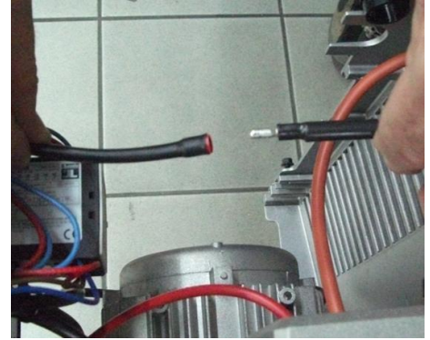
15) Подсоединить кабель электрода ионизации к разъему
