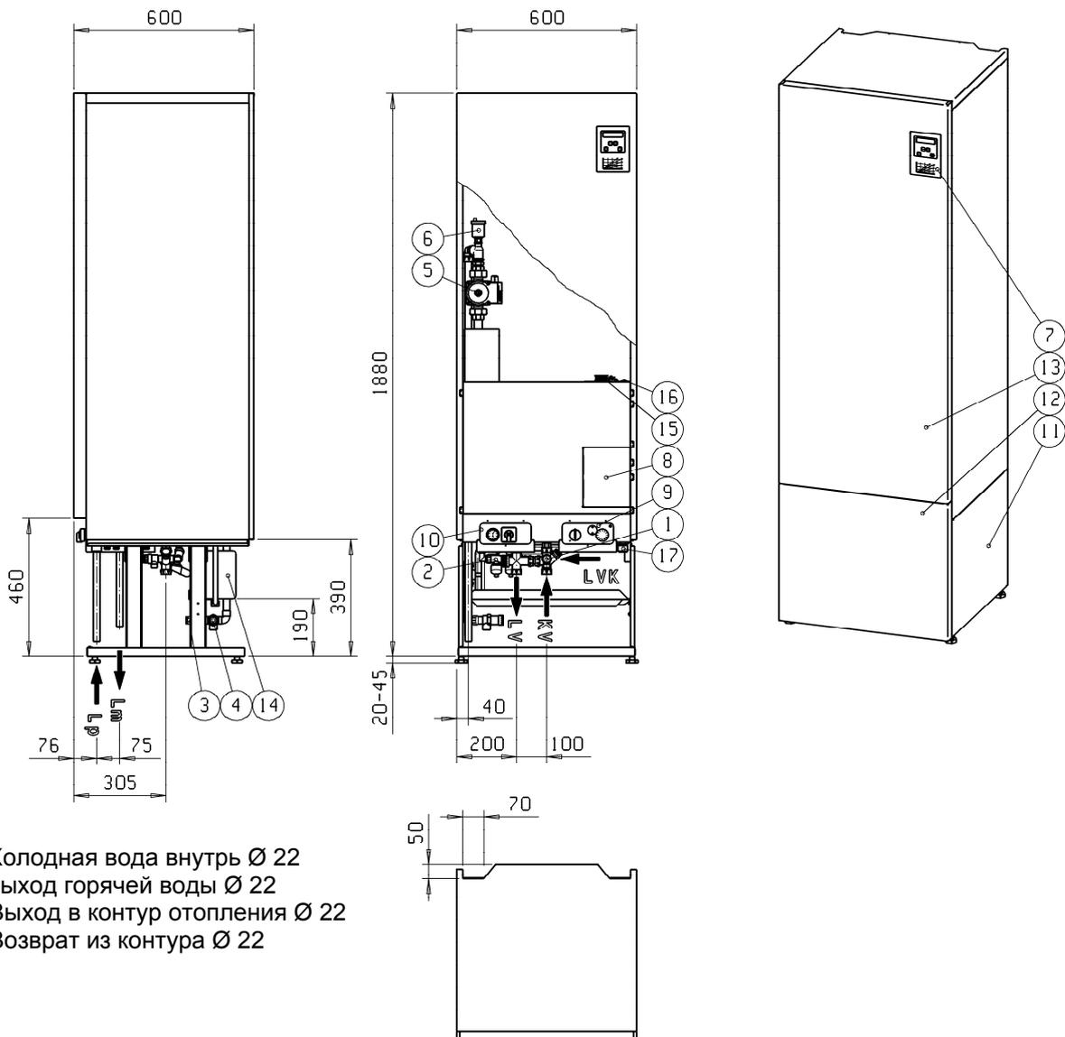
KV = Холодная вода внутрь Ø 22
