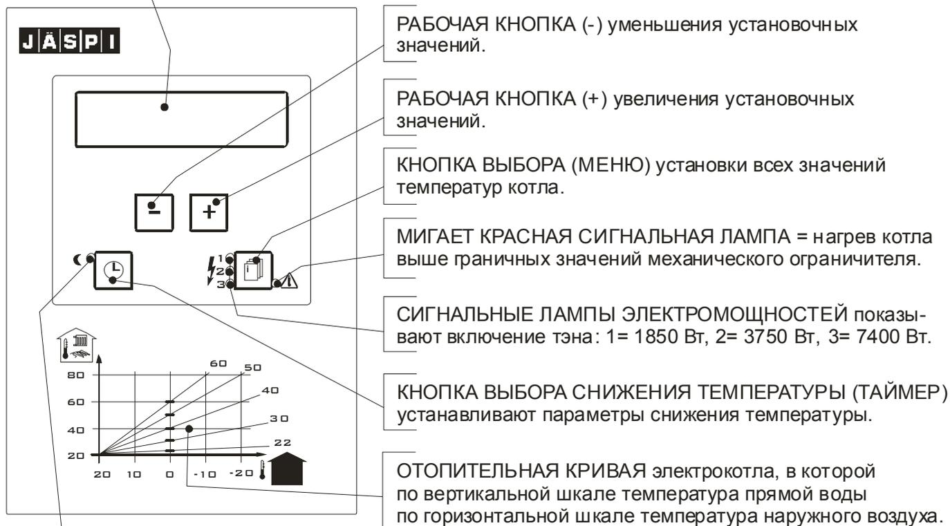
СИГНАЛЬНАЯ ЛАМПА функции снижения температуры
