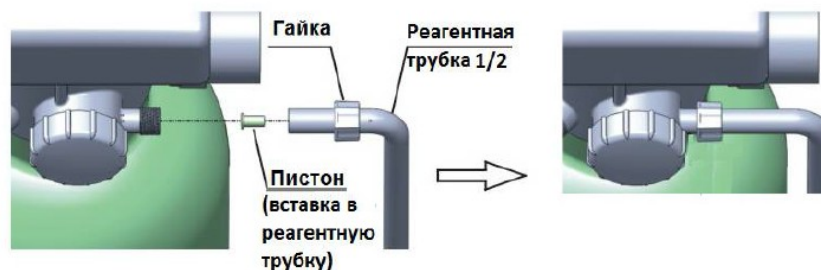
Рисунок 4 — Подключение реагентной линии в установках WS-5,0-Rx-(BS)-WS-8,0-Rx-(BS)
