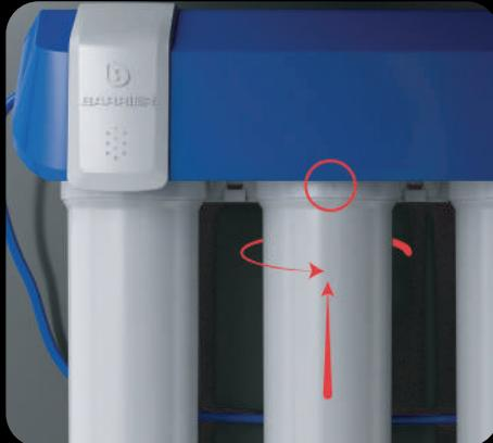
Вставьте колбу в блок фильтра и поверните против часовой стрелки до совмещения меток «треугольников».
