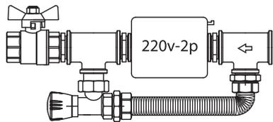
При подключении выходного патрубка соблюдайте манипуляционные знаки нанесенные на корпусе двухходового клапана и электропривода.
