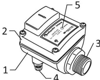
Блок управления ТУРБИ-М1 состоит из герметичного пластикового корпуса - (1) и верхней крышки с резиновой прокладкой (2). На корпусе расположены два присоединительных резьбовых патрубка с наружной резьбой 1" – (3), а также два кабельных ввода – (4). На верхней крышке
