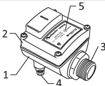
Блок управления ТУРБИ-М2 состоит из герметичного пластикового корпуса - (1) и верхней крышки с резиновой прокладкой (2). На корпусе расположены два присоединительных резьбовых патрубка с наружной резьбой 1" – (3), а также два кабельных ввода – (4). На верхней крышке
