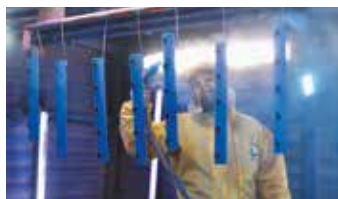
Полуавтоматическая порошковая окраска поверхностей
