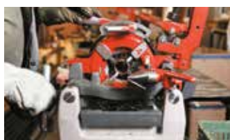
Автоматическое нарезание резьбы
