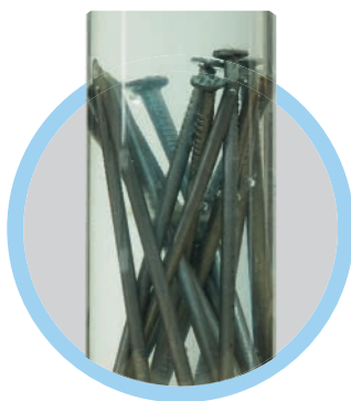
Образцы стали в антикоррозийной котловой воде Warme Hydro
