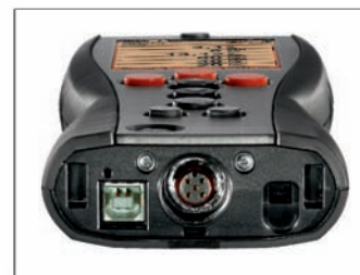
Разъемы на управляющем модуле
