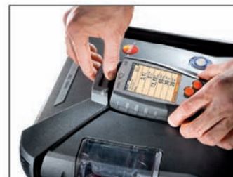
Управляющий модуль просто "защелкивается" в блок анализатора
