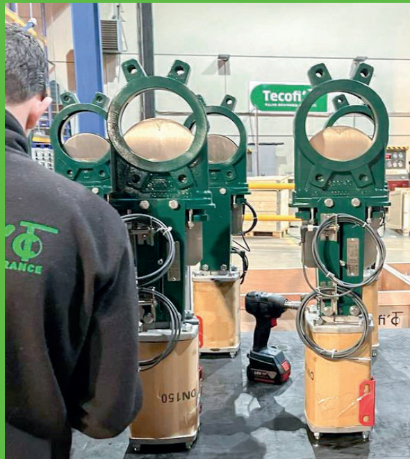
Montage kit contacts fin de course inductif version ATEX sur vannes à guillotine TECKNIFE
