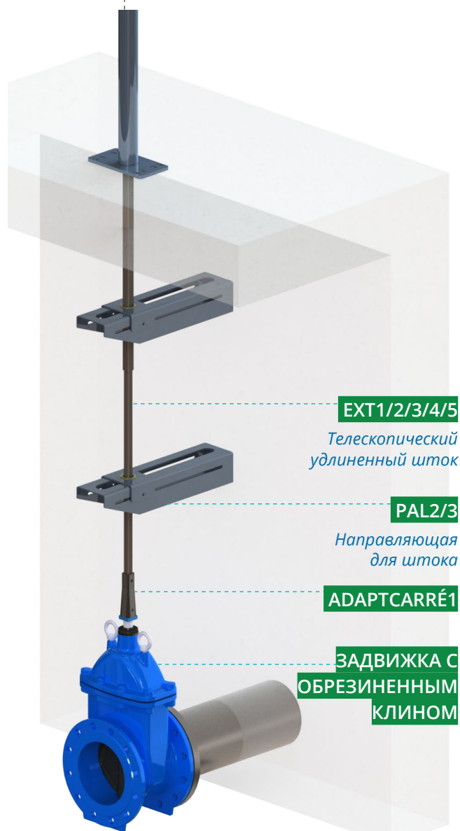
Монтаж на задвижку VOC4241C-051
