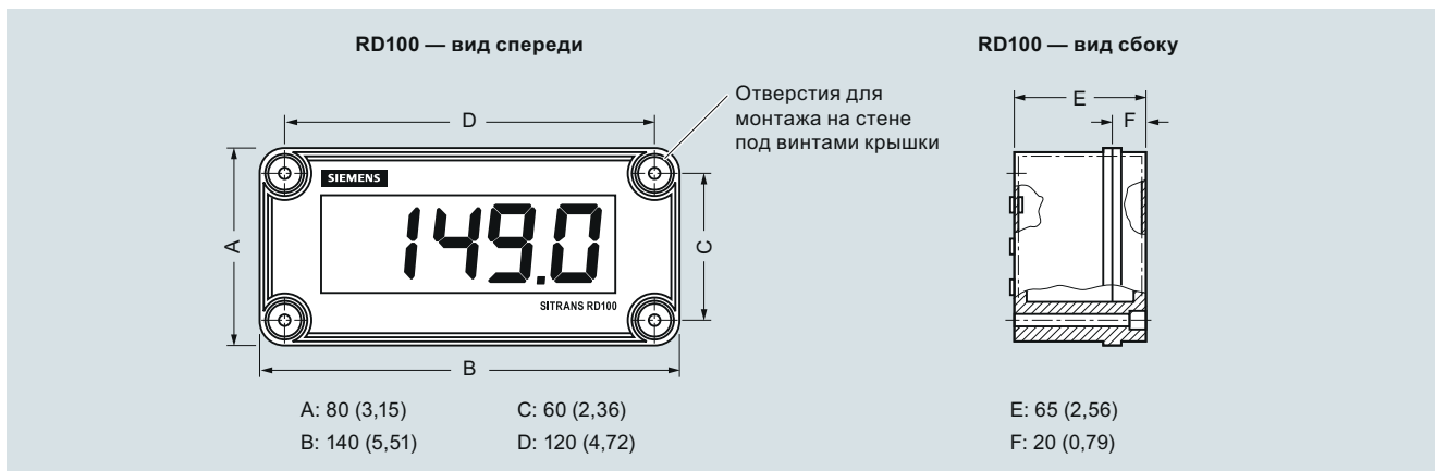
SITRANS RD100, размеры в мм (дюймах)
