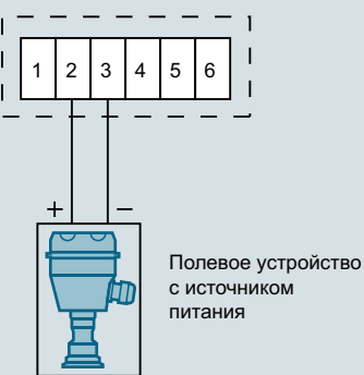
Подключение 4-проводного полевого устройства
