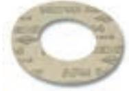
Hochdruck-Flanschdichtung asbestfrei für Vorschweiß-, Gewinde-, Press- und lose Flanschen geeignet bis maximal 400°C, beständig gegen Wasser, Dampf, Treibstoffe, verdünnte Laugen, Öle, Gase (DVGW-geprüft nach DIN 3535 Teil 6). Abmessungen nach DIN EN 1514-1, 2 mm dick für Flanschen. PN 10/16 = DIN EN 1092-1 und DIN EN 1092-2
