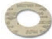
Hochdruck-Flanschdichtung asbestfrei für Vorschweiß-, Gewinde-, Press- und lose Flanschen geeignet bis maximal 400°C, beständig gegen Wasser, Dampf, Treibstoffe, verdünnte Laugen, Öle, Gase (DVGW-geprüft nach DIN 3535 Teil 6). Abmessungen nach DIN EN 1514-1, 2 mm dick für Flanschen. PN 10/16 = DIN EN 1092-1 und DIN EN 1092-2
