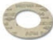
Hochdruck-Flanschdichtung asbestfrei für Vorschweiß-, Gewinde-, Press- und lose Flanschen geeignet bis maximal 400°C, beständig gegen Wasser, Dampf, Treibstoffe, verdünnte Laugen, Öle, Gase (DVGW-geprüft nach DIN 3535 Teil 6). Abmessungen nach DIN EN 1514-1, 2 mm dick für Flanschen. PN 10/16 = DIN EN 1092-1 und DIN EN 1092-2
