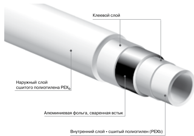
Рисунок 1. Структура трубы PE-Xb/Al/PE-Xb
