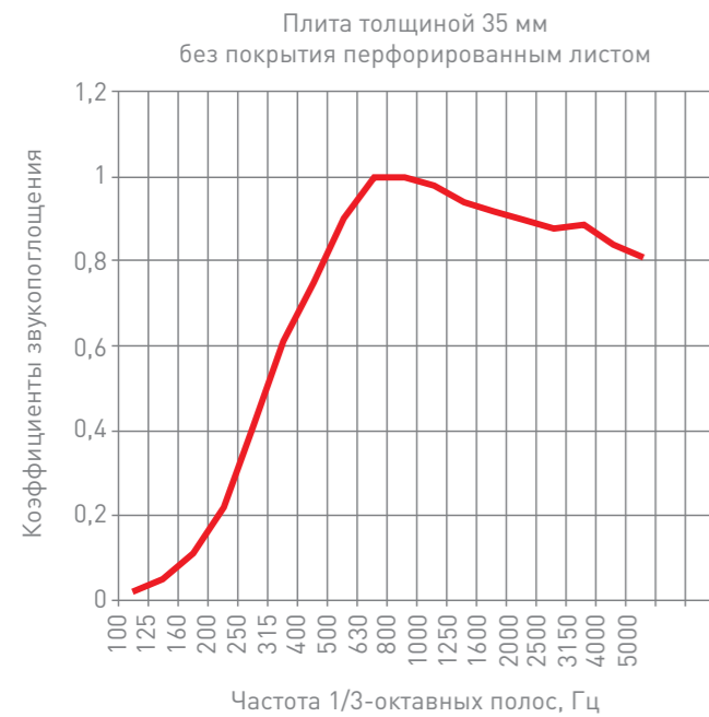
Рисунок 49. Частотные характеристики реверберационных коэффициентов звукопоглощения плит из полимерной ваты INDUSTRIAL BATTs 80 плотностью 80 кг/м 3 , толщиной 35 и 50 мм, кашированных, с покрытием и без покрытия перфорированным листом
