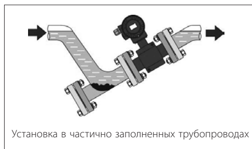
Расходомер устанавливается электронным блоком ВВЕРХ
